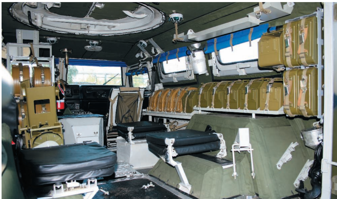
Расположение укладок под магазин-коробки с боеприпасами в салоне СТС ГАЗ-233014 «Тигр».
