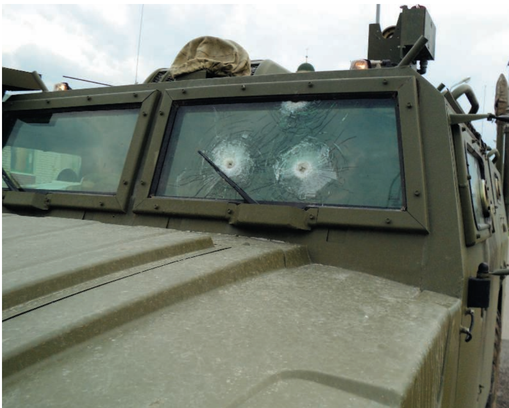
Бронеавтомобиль «Тигр» Р-145БМА подразделения внутренних войск МВД РФ после одного из боев.
