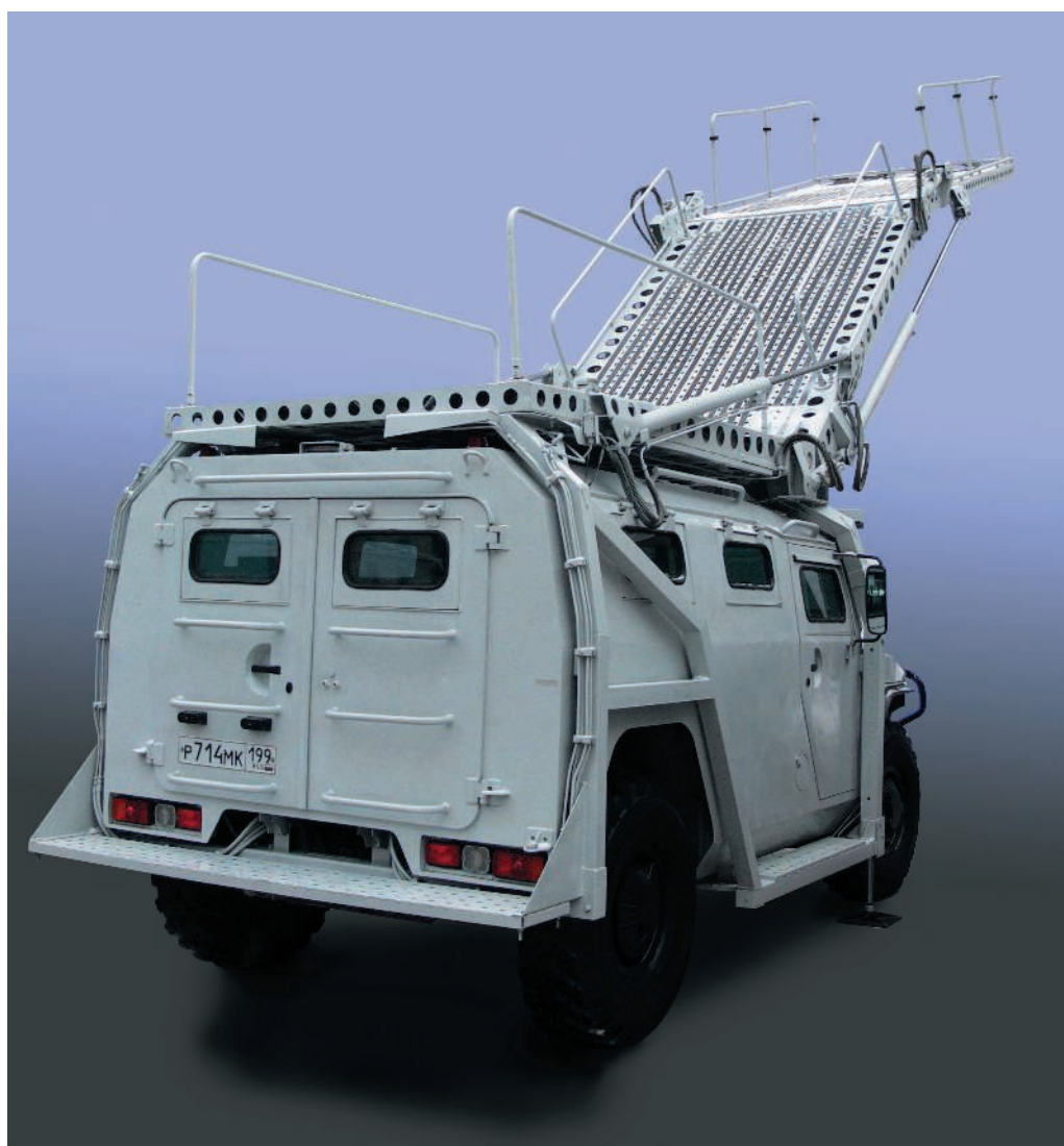
Спецавтомобиль «Тигр» «Абаим-Абанат» с развернутым штурмовым трапом.
