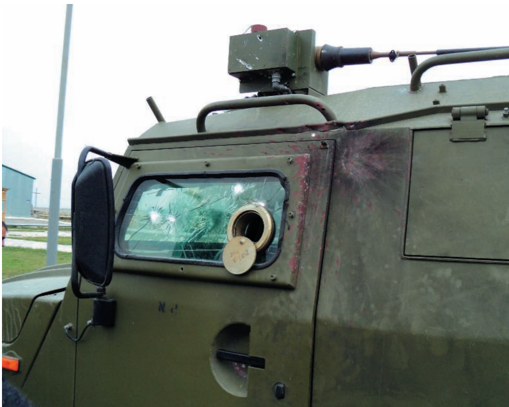
Отметины на корпусе КШМ «Тигр» Р-145БМА после обстрела из засады.
