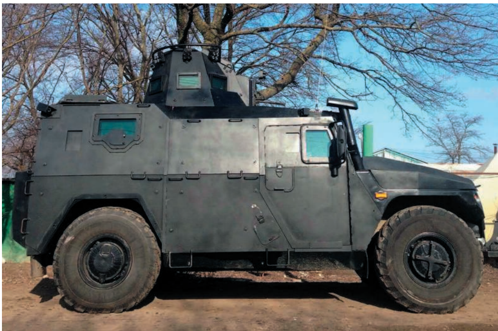
Специальная штурмовая машина «Тигр» спецназа ФСБ России оснащена дополнительным бронированием по-максимуму.
