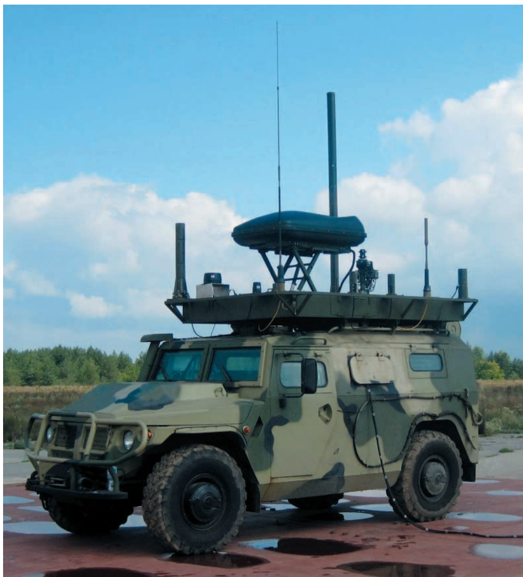
Бронеавтомобиль «Тигр-М» мобильный комплекс технического контроля, радиоэлектронной имитации и постановки помех «Леер-2».
