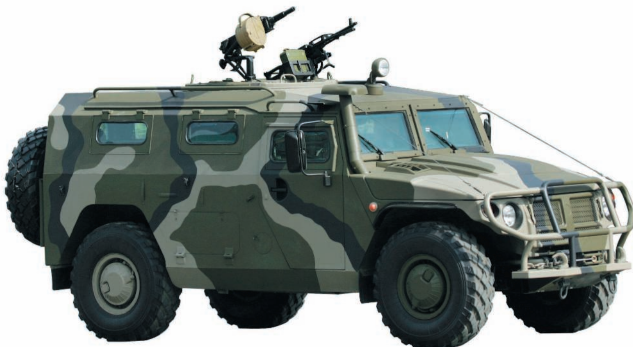
СТС ГАЗ-233014 «Тигр» с установленными 7,62-мм пулеметом ПКП «Печенег» и 30-мм автоматическим гранатометом АГС-17.
