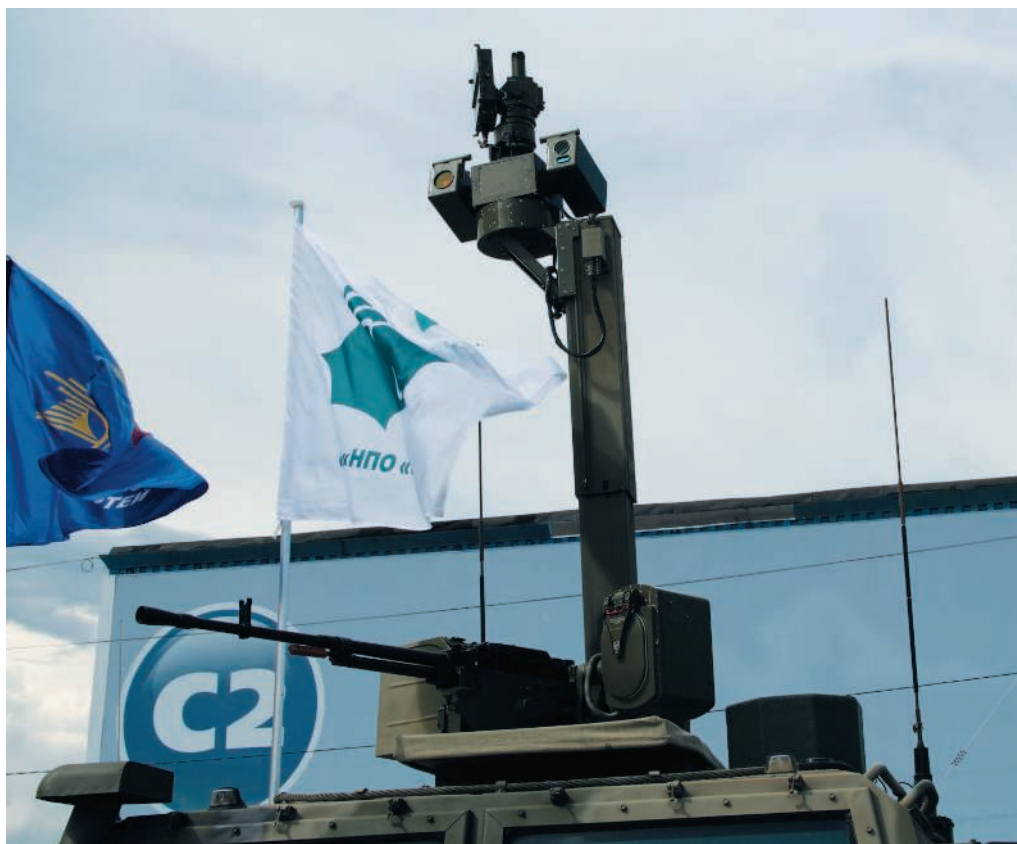
Развернутая мачта с комплексом разведки и наблюдения СБРМ «Тигр».
