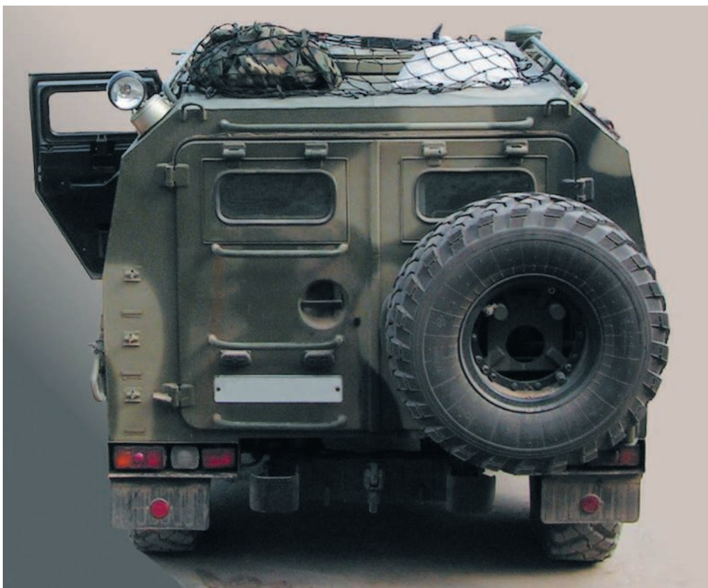
СТС ГАЗ-233014 «Тигр» на крыше сеть для крепления рейдовых рюкзаков боевого расчета.
