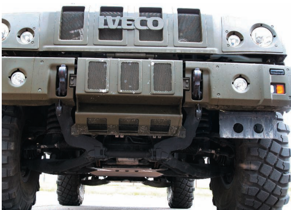
Опускающиеся вниз рычаги подвески автомобиля Iveco LMV M65 уменьшают заявленный клиренс машины с 425 мм до 290 мм.
