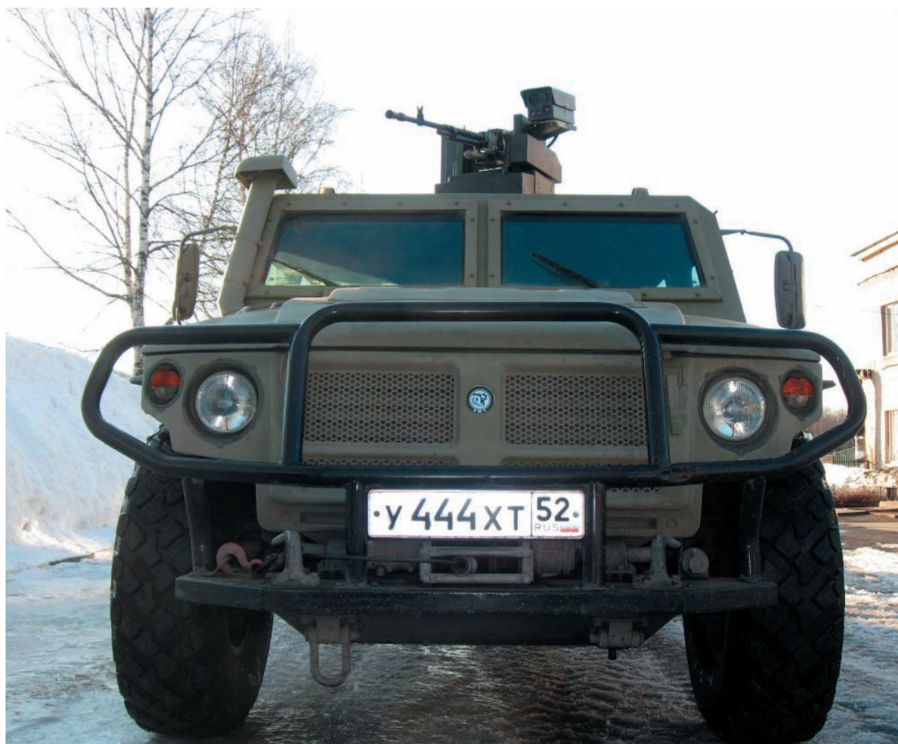
Бронеавтомобиль СПМ-2 «Тигр» с боевым модулем АДУНОК, оснащенным 12,7-мм пулеметом НСВТ-12,7 «Утес».
