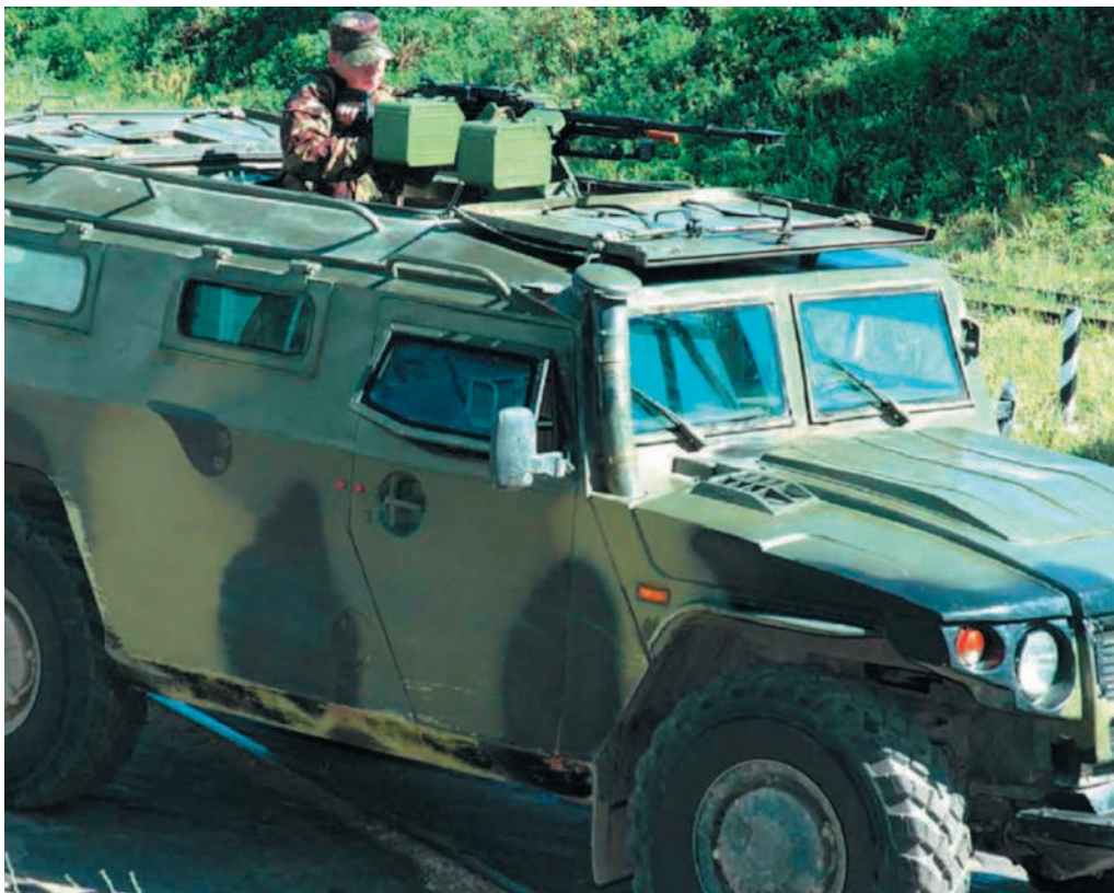
Опытный образец СТС ГАЗ-233004 «Тигр» с установленным на него вооружением.
