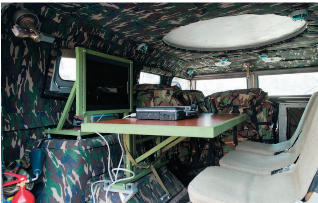
Рабочие места расчета мобильного комплекса с БЛА на шасси СТС «Тигр».
