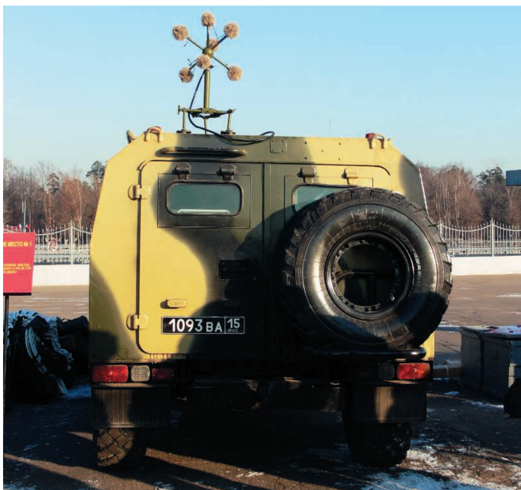
Акустический датчик системы обнаружения снайперов.
