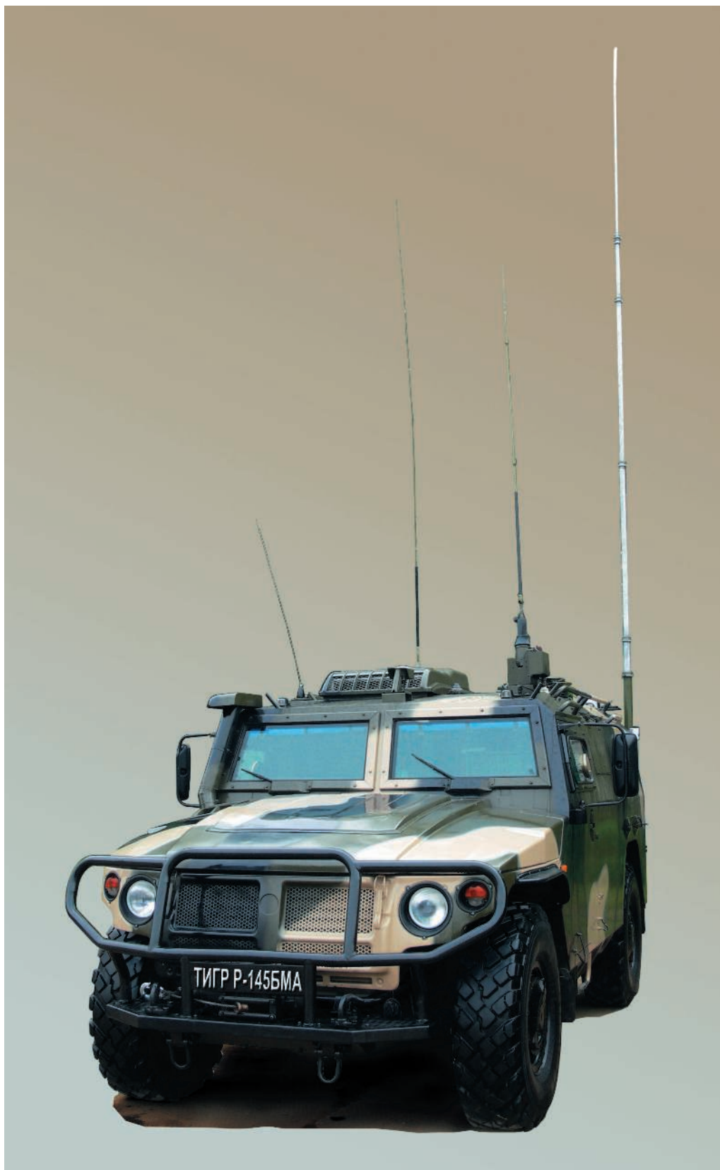
Командно- штабная машина Р-145БМА «Тигр» с развернутым антенно-мачтовым устройством.
