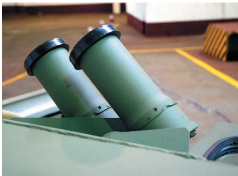
Пусковые установки системы 902Г, смонтированные на крыше «Тигра-М СпН».
