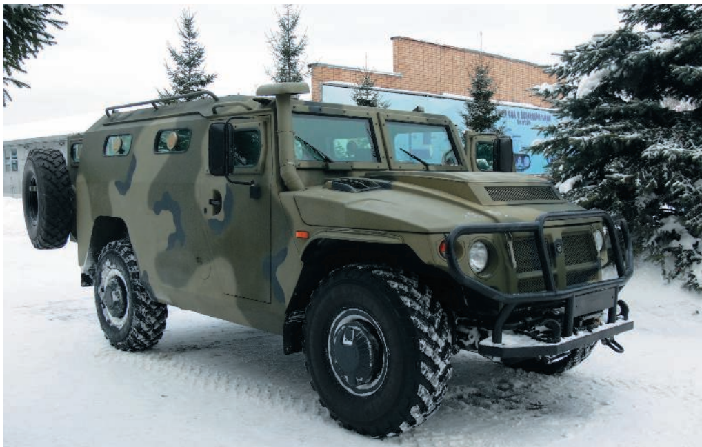
Бронированный автомобиль «Тигр» проект 420» с двигателем мощностью 420 л.с.
