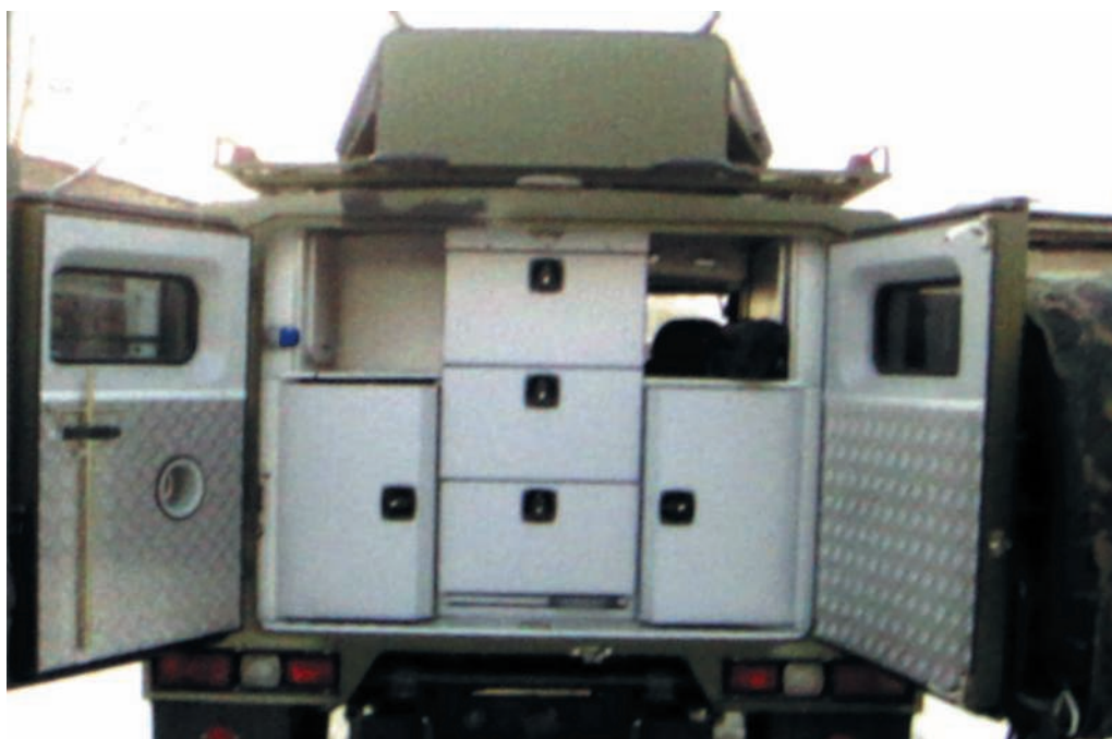
Аппаратурный отсек комплекса «Спектр», оборудованный в багажном отсеке автомобиля ГАЗ-233001 «Тигр».
