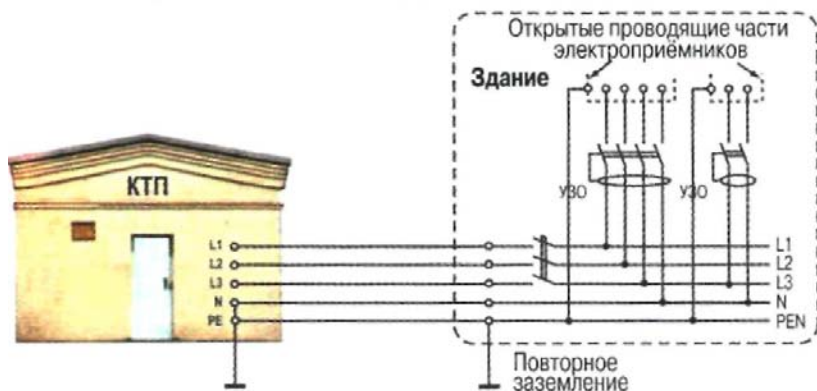
Применение УЗО в электроустановке системы TN-S
