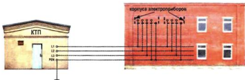
Система заземления TN, подсистема TN-C
